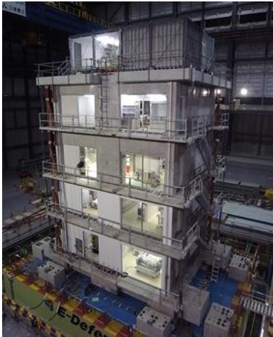
写真 1：振動台上に設置された試験体
