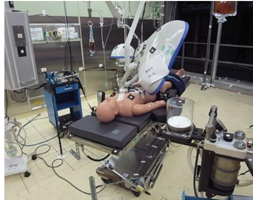
写真 2：試験体内の手術室では、手術台にマネキンを固定し振動実験を行った
