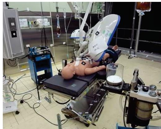
写真2：試験体内部の手術室では、手術台にマネキンを固定し振動実験を行った
