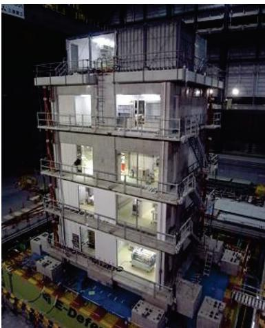
写真1：振動台に設置された試験体
